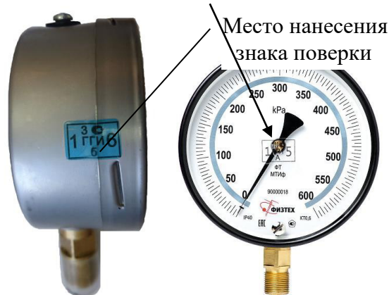
Рисунок 12 – Место нанесения знака поверки
