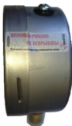
Рисунок 11 – Заводская пломбировка с помощью наклейки
