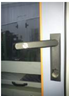
Рисунок 9 – Внешний вид замка на дверце стойки управления
