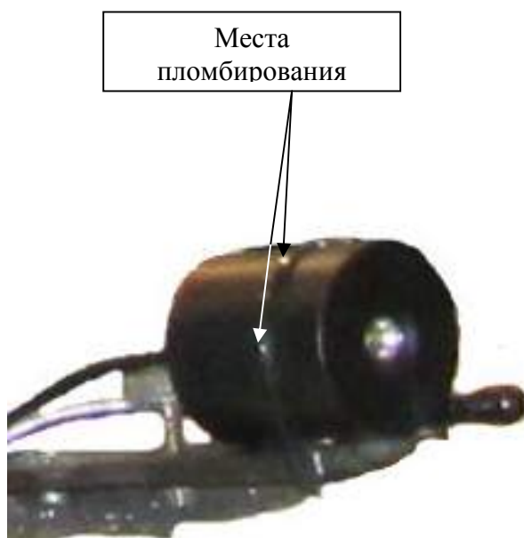
Рисунок 3 - Общий вид радиометрической головки с указанием мест пломбирования
