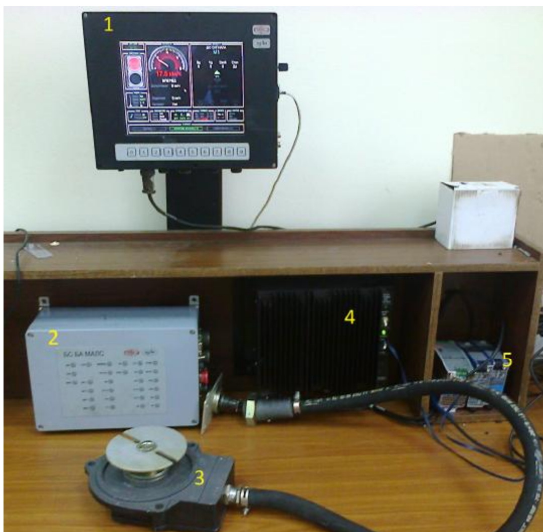
Рисунок 2. Общий вид комплексов для измерения скорости движения локомотива 1 - БВ – блок вычислительный; 2 - БС – блок сопряжения; 3 - ДИ – датчик импульсов; 4 - ИП/ЛЭ – источник питания; 5 - Линейка клемм.
