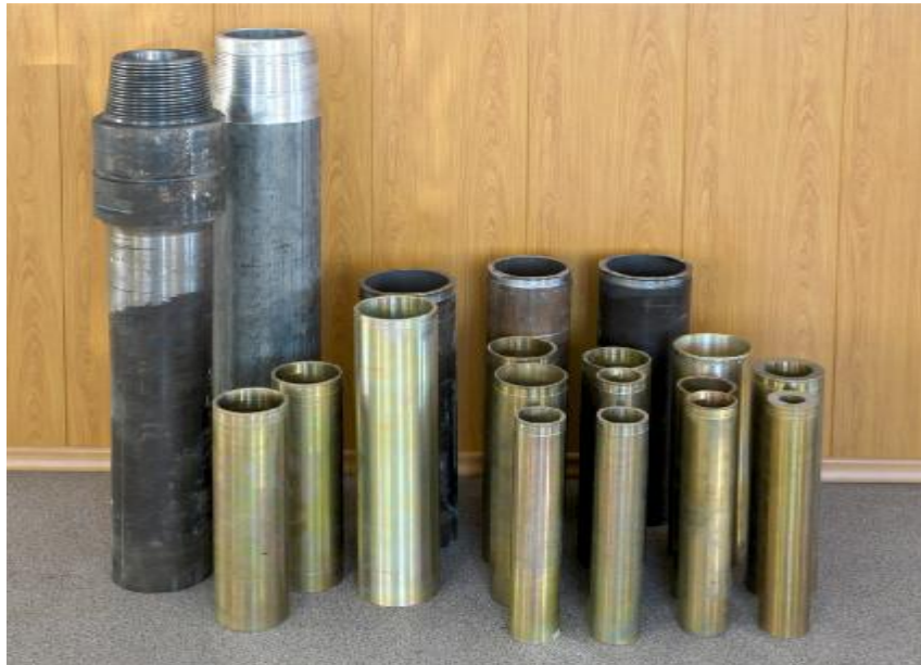
Рисунок 1 – Внешний вид мер неразрушающего контроля из комплекта КМНК-500
