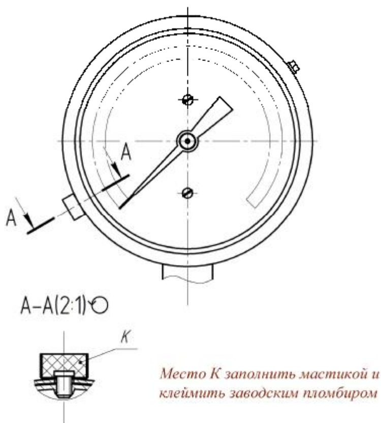
Рисунок 2 – Место пломбирования манометров, вакуумметров и мановакуумметров для точных измерений типов МТИ и ВТИ
