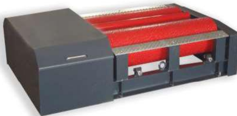
Рисунок 1 – Стенды силовые роликовые тормозные с наварным покрытием роликов
