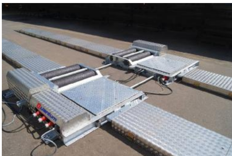
Рисунок 3 – Стенды силовые роликовые тормозные мобильного исполнения
