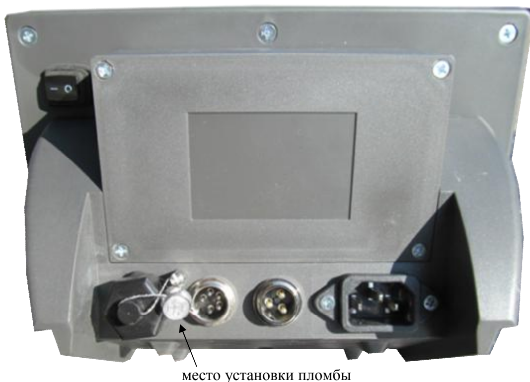
Рисунок 2 – Схема пломбировки индикаторов
