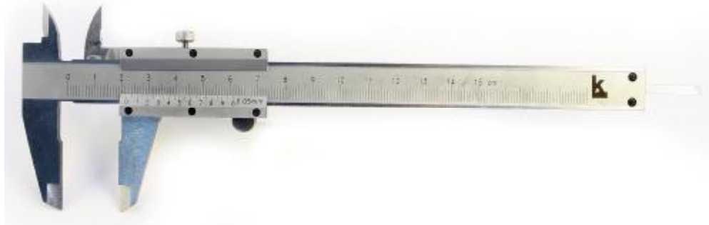
Рисунок 1 – Общий вид штангенциркулей двусторонних с глубиномером с отсчетом по нониусу.
