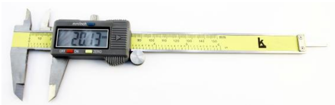
Рисунок 3 – Общий вид штангенциркулей двусторонних с глубиномером с цифровым отсчетным устройством.
