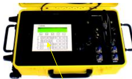
Рис. 6 Место нанесения клейма (пломбы) на калибраторы давления мод. 6200, 6250, 6300, 6300-M3, 6300-M4, 6600, 6600-M4H
