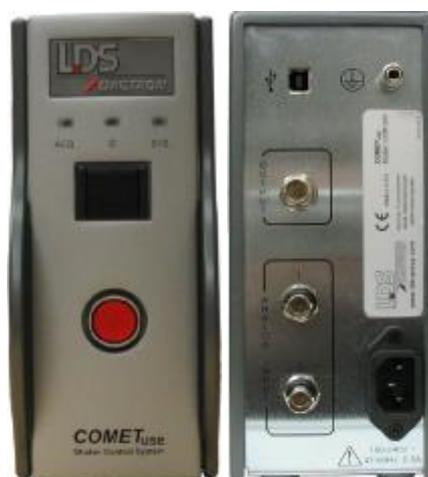
Рисунок 2- Аппаратура измерительно-управляющая для вибрационных испытаний COMET
