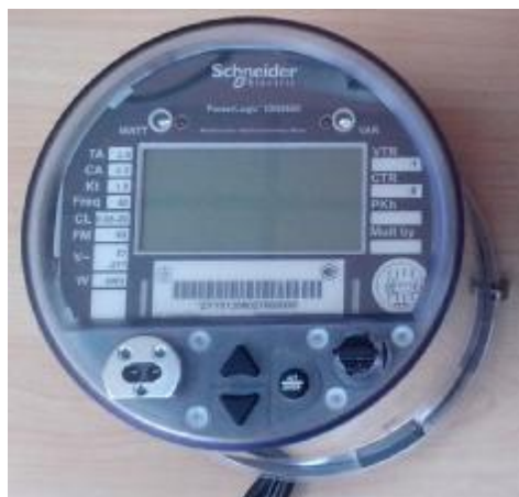
Рисунок 2. Внешний вид счетчиков электроэнергии многофункциональные ION 8600
