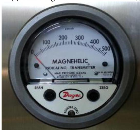
Рис. 1. Внешний вид датчика давления Magnehelic 605 модель 605-500Pa.
