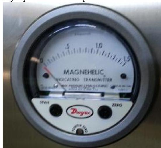
Рис. 2. Внешний вид датчика давления Magnehelic 605 модель 605-1,5kPa.
