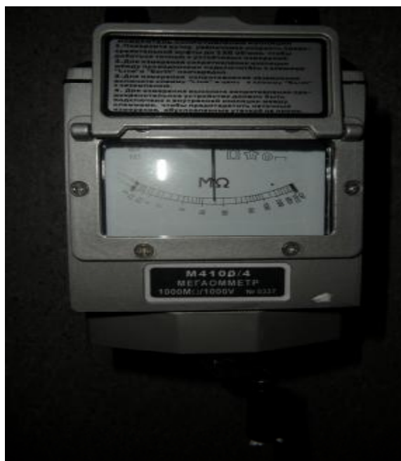
Рисунок 1 - Общий вид мегаомметра
