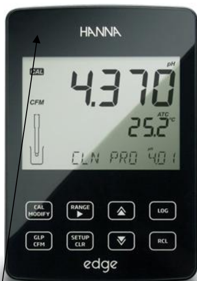
Рисунок 1 – фотография внешнего вида анализатора Место нанесения знака поверки
