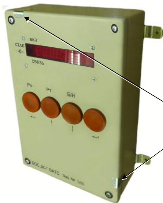
Рис. 4 – Места пломбирования БОС ДСТ ВАТС
