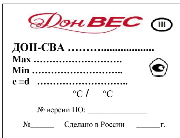
Рисунок 3 Маркировка весов автомобильных электронных ДОН-СВА
