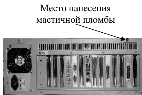
Рисунок 4 – Схема пломбировки индикатора М1РС-01 и терминала М1РС-03
