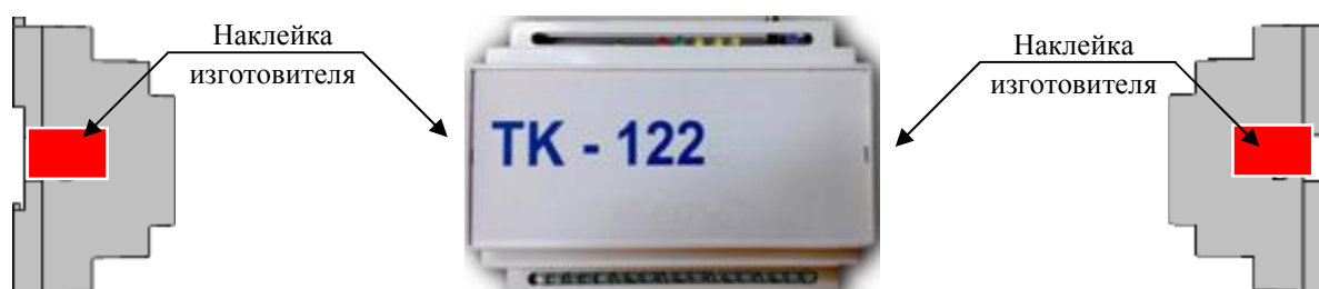
Рисунок 1 – Общий вид УСПД и мест пломбировки
