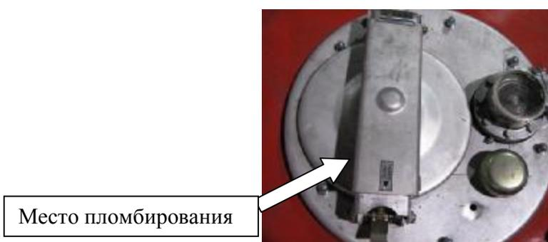
Рисунок 5 – Запорный механизм крышки заливной горловины АТЗ
