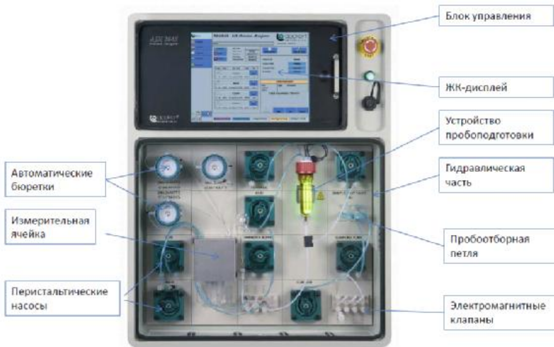
Рис. 2 Основные узлы анализатора ADI 2045 VA
