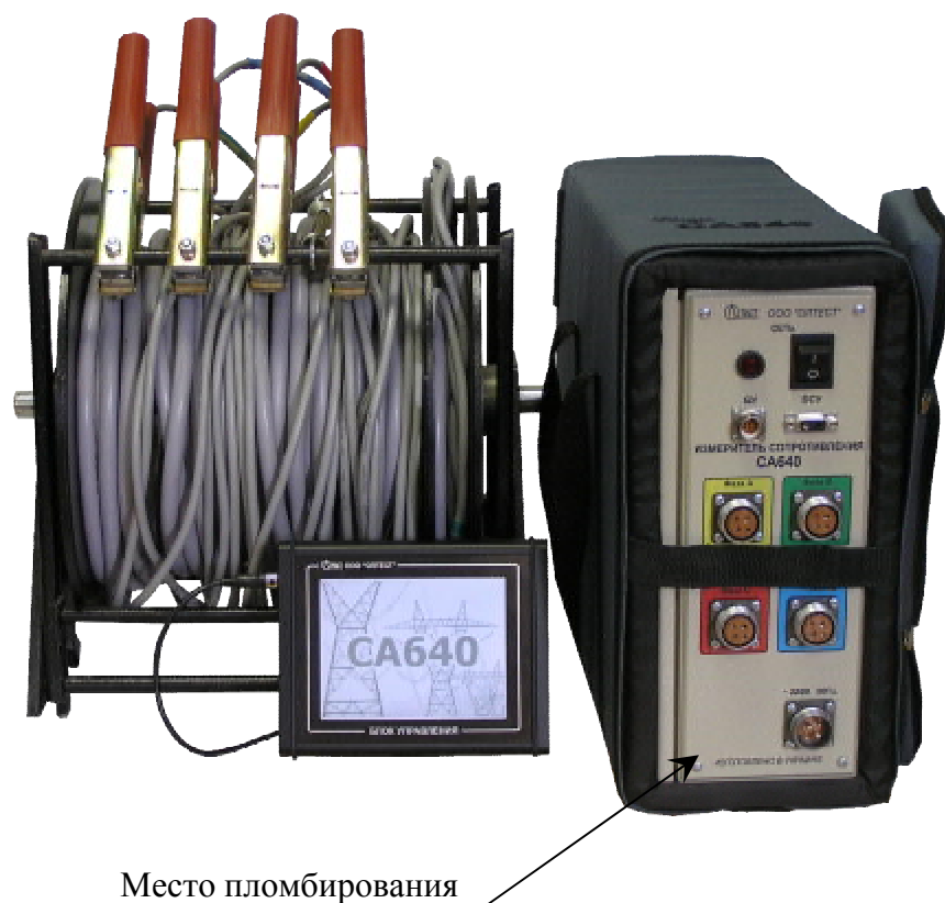
Рис. 1 – Внешний вид измерителя CA640, кабеля измерительного и блока управления
