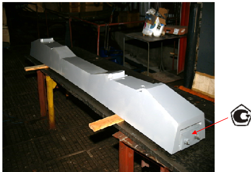
Рисунок 1 – Общий вид мер для поверки систем автоматизированного контроля геометрических параметров железобетонных шпал.
