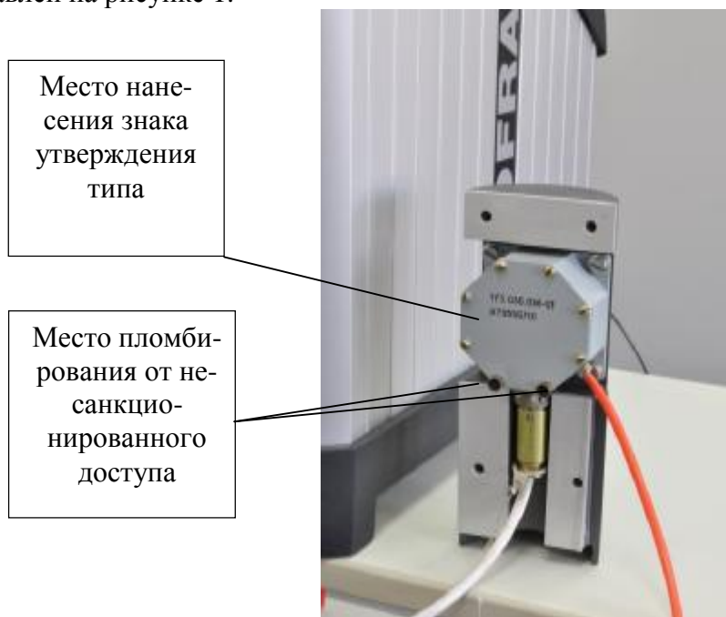
Рисунок 1 - Внешний вид и схема пломбировки Кварц ПП от несанкционированного доступа
