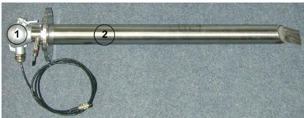
1- сенсор 2- устройство отбора пробы при высокой температуре с фланцем
