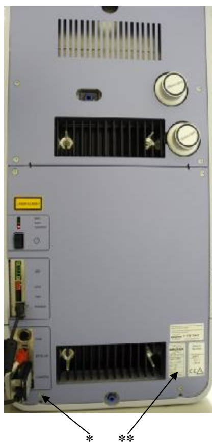
Рисунок 2- Задняя панель ИК-Фурье-микроскопа LUMOS, *- место пломбирования, ** - место маркировки
