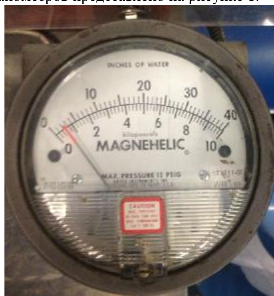
Рис. 1. Внешний вид манометра показывающего MAGNEHELIC 2040D.
