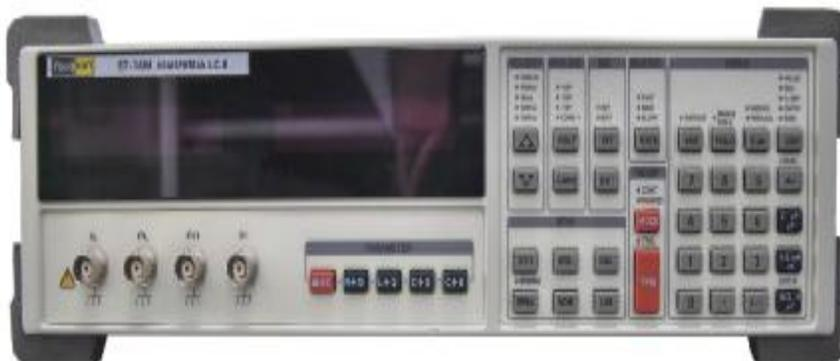
Рисунок 1 – Общий вид передней панели измерителя иммитанса
