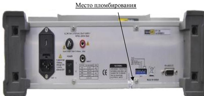
Рисунок 2 – Вид задней панели измерителя иммитанса
