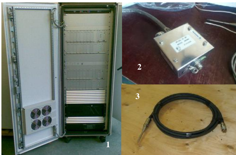
Рисунок 1 - Составные части системы: 1. Устройства информационно-измерительные УИ-ххАЦ; 2. Коммутационная коробка КК-А; 3. Акустический датчик GT400
