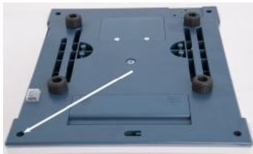
а) пломбирование настольных весов
