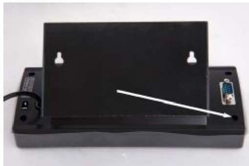
б) пломбирование напольных весов
