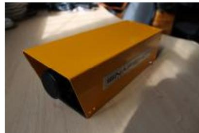
Рисунок 5 - Видеокамера высокоскоростная
