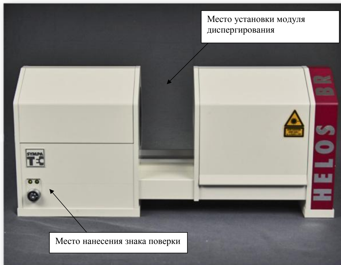
Рисунок 1 – фото внешнего вида анализатора HELOS
