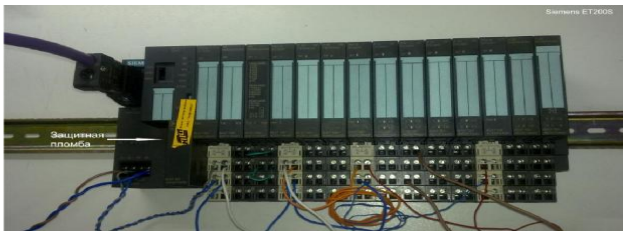
Рисунок 3 - Схема пломбирования контроллера «Siemens»
