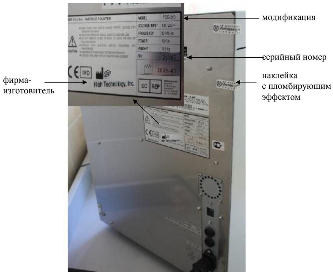
Рисунок 2 – Схема маркировки и пломбировки
