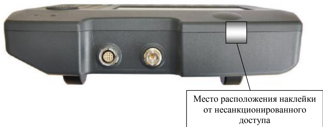
Рисунок 2 – Анализатор сигналов (базовый блок). Схема пломбировки от несанкционированного доступа
