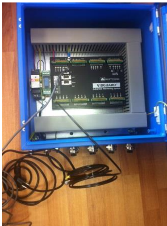
Рисунок 1- система измерений и мониторинга вибрации VIBGUARD
