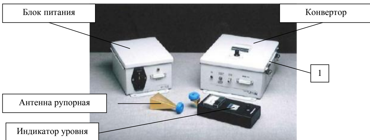
Рисунок 4 – Комплекс R&S MW-58. Схема пломбировки от несанкционированного доступа
