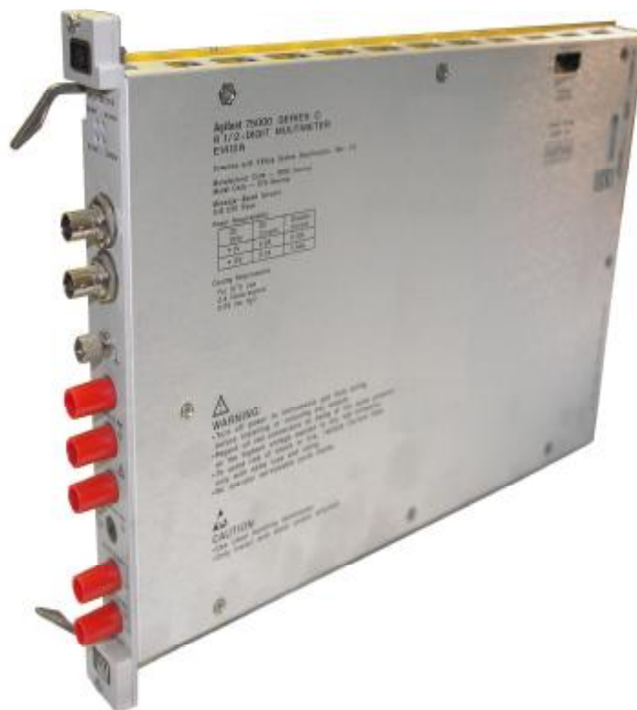
Рисунок 1 Фото общего вида мультиметра E1412A
