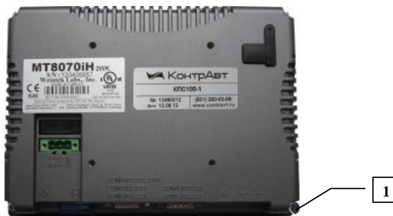
Рисунок 2 – Защита панели оператора прибора от несанкционированного вскрытия с помощью поверительного клейма
