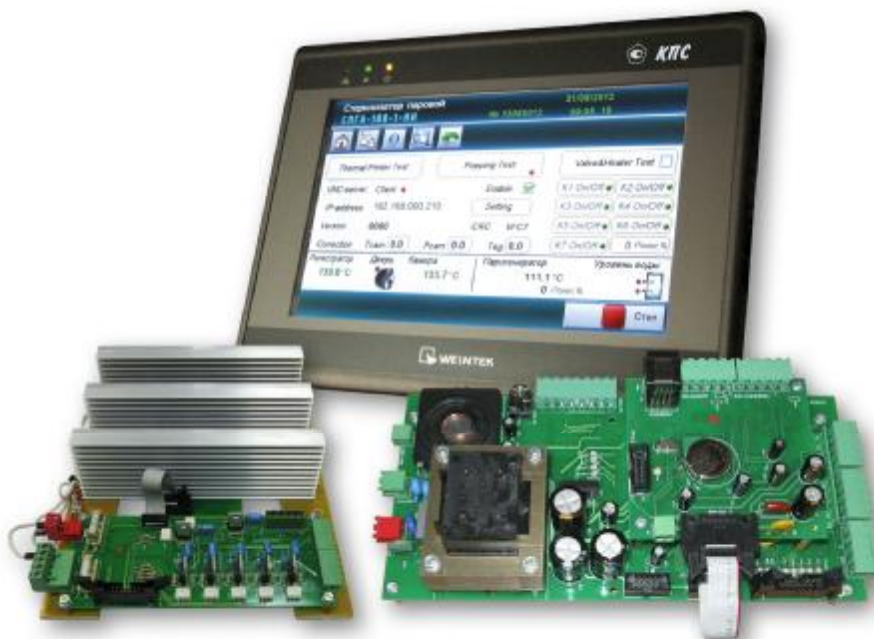
Рисунок 1- Общий вид прибора: блок управления с блоком регистрации, панель оператора и блок силовых ключей
