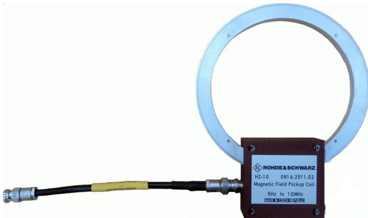
Рисунок 1 – Внешний вид антенны с кабелем
