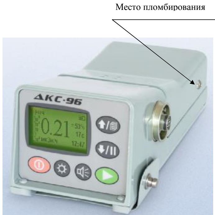
Рисунок 1в – Пульт измерительный УИК-05
