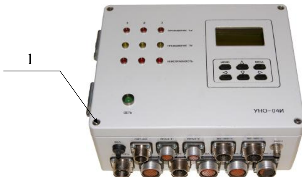
1 – Пломба с оттиском клейма поверителя Рисунок 4 – Внешний вид блока УНО-04И
