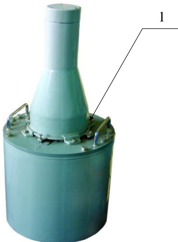
1 – Пломба с оттиском клейма поверителя Рисунок 3 – Внешний вид БДГБ-03И
