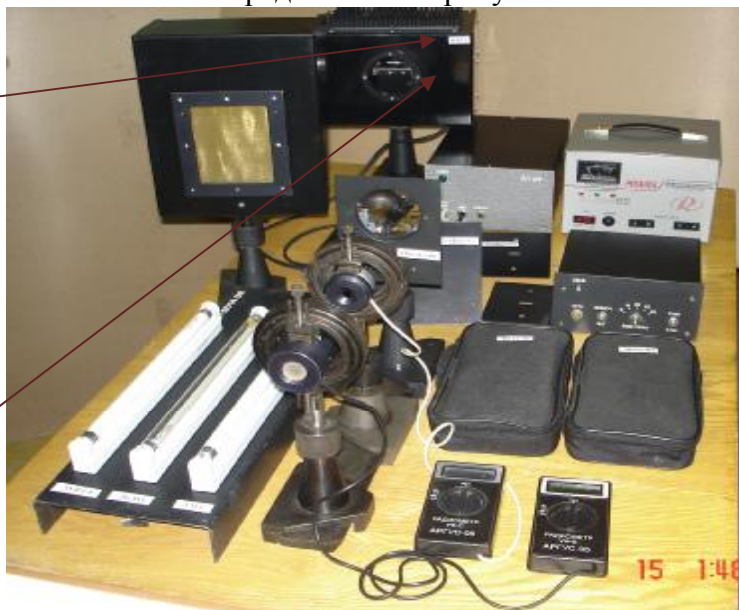
Рисунок 1- Общий вид установок «Стильб-М» и места нанесения маркировки и пломбирования.
