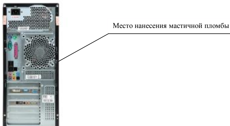
Рисунок 4 – Схема пломбировки системного блока ПЭВМ.
