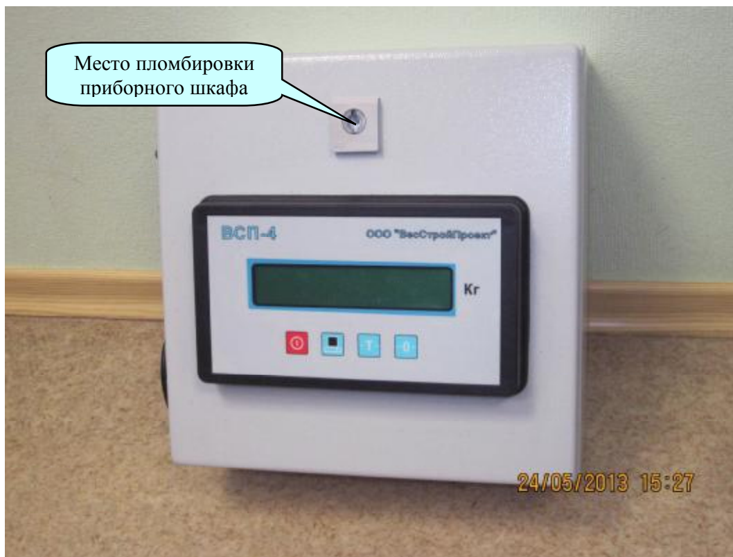
Рисунок 3 Внешний вид индикатора ВСП-4 в приборном шкафу ТНМ-55-30.30.15 и схема пломбировки от несанкционированного доступа
