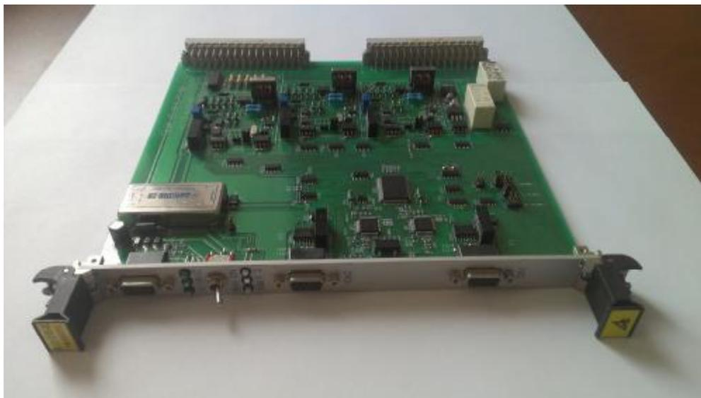
Клеймо поверителя ставится специальной печатью красного цвета на печатную плату со стороны установки элементов на свободное место между разъемами модуля.
