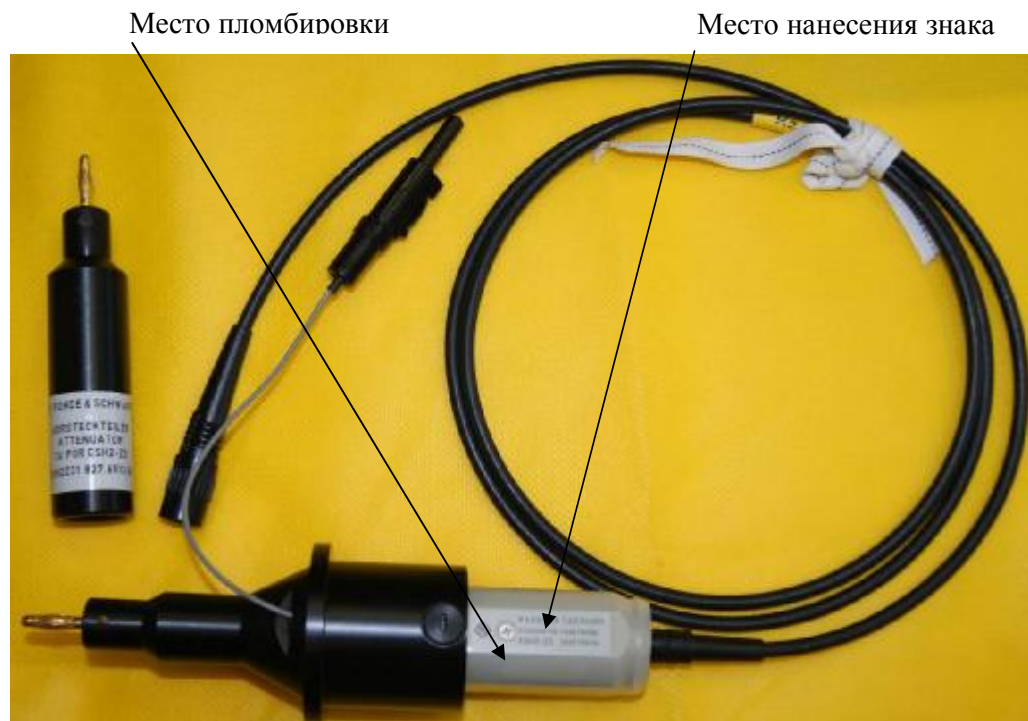
Рисунок 1 – Внешний вид ESH2-Z3 с аттенуатором ESH2-Z31
