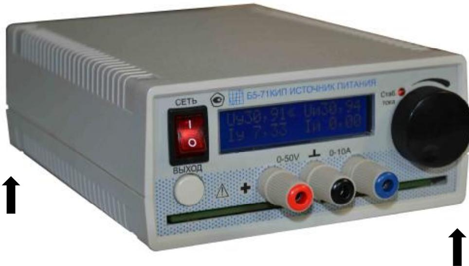
Рисунок 1. Внешний вид Б5-71КИП. Стрелкой отмечено место пломбирования.
