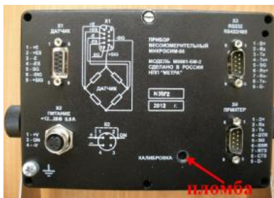
Рисунок 2 Общий вид и место пломбирования Микросим 06
