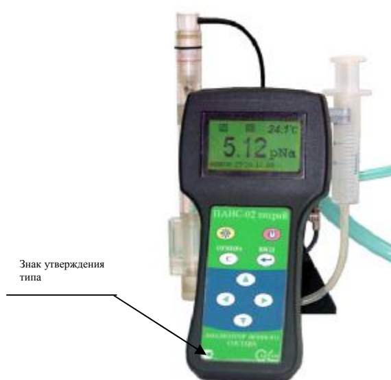
Рисунок 2 - Анализатор ионного состава потенциометрический ПАИС-02натрий
